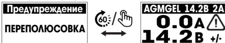
При правильном подключении работоспособность ЗУ автоматически восстанавливается, пиктограмма ошибки исчезает.
