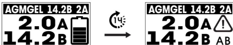
Если по истечению 5 часов после появления предупреждения значения напряжения и протекающего тока не изменялись зарядное устройство автоматически уменьшит ток заряда и перейдет в режим хранения АКБ.
