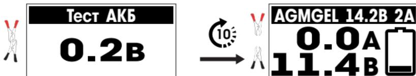
На экране «Тест АКБ» будет отображаться напряжение (0-0,4 В) падения на проводах в режиме короткого замыкания (далее КЗ). После появления основного экрана разомкните выходные зажимы и убедитесь, что значение тока на экране находится в диапазоне 0-0,2 А.
