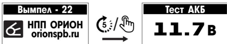
На экране в течении 10 секунд будет отображаться «Тест АКБ»: действующее напряжение на выходных зажимах ЗУ.
