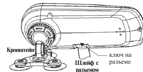
Для быстрого отключения компьютера отсоедините шлейф. Рис. 2.4.
