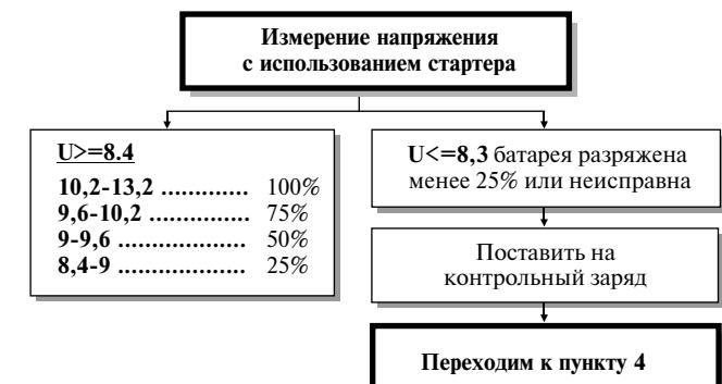
**Пункт 4.** Проверка аккумуляторной батареи Электронной нагрузочной вилкой, в качестве нагрузки используется стартер. (Батарею заряжали в пунктах 2 или 3.)
