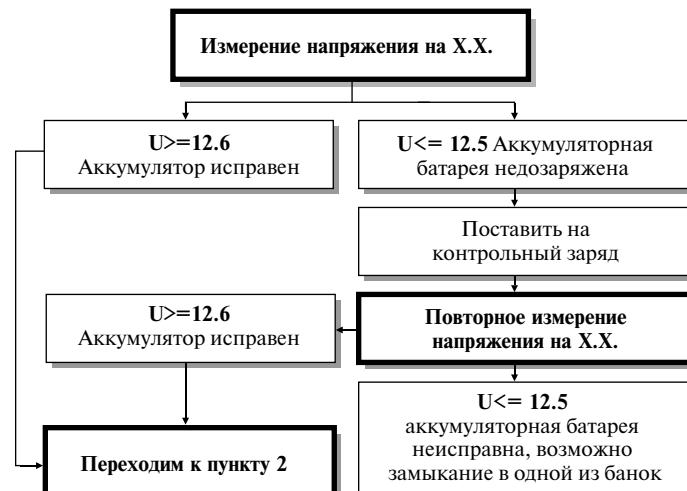
**Пункт 2.** Проверка аккумуляторной батареи слаботочной нагрузкой.
