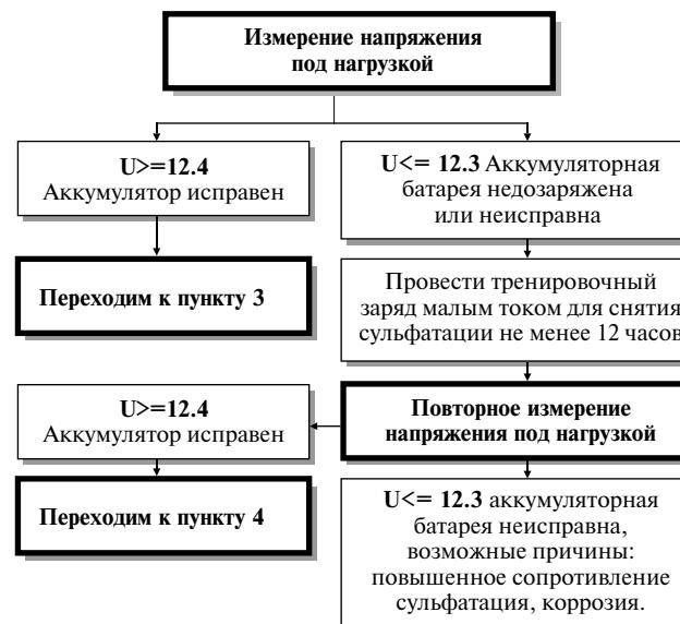
**Пункт 3.** Проверка аккумуляторной батареи Электронной нагрузочной вилкой, в качестве нагрузки используется стартер. (батарея не заряжалась в пункте 1 или пункте 2)
